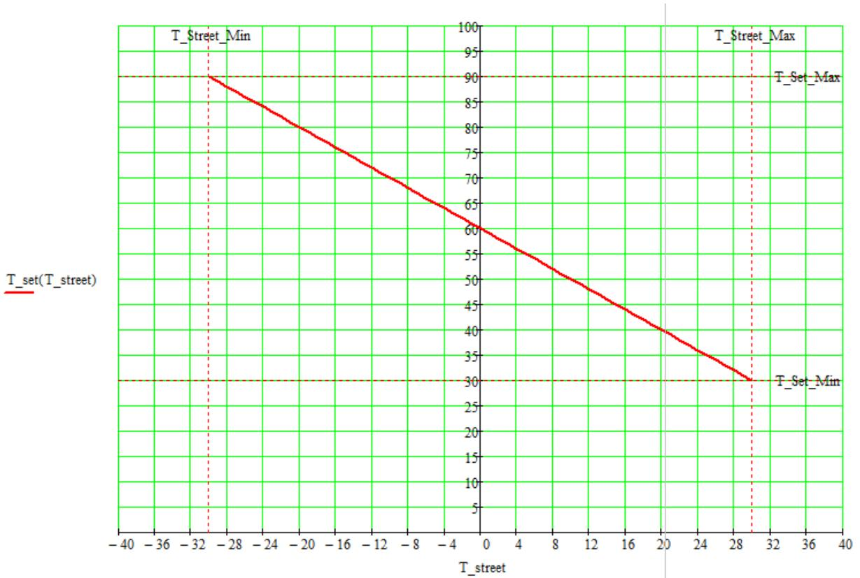
Где  $T_{set}$  – погодозависимая уставка,  $T_{street}$  – текущая температура на улице,  $T_{Set\_Max}$  – верхняя точка уставки,  $T_{Set\_Min}$  – нижняя точка уставки,  $T_{Street\_Max}$  – верхняя точка температура на улице,  $T_{Street\_Min}$  – нижняя точка температура на улице.
