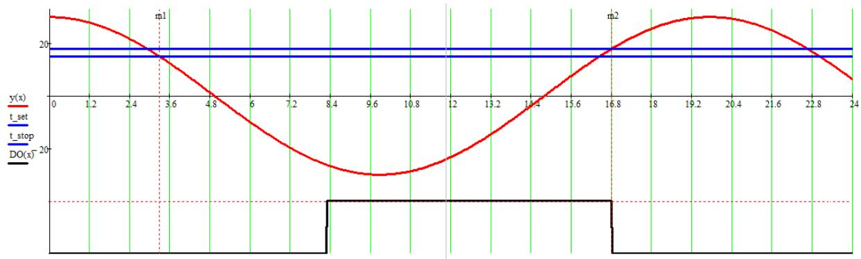
Где  $y(x)$  - текущая температура на улице,  $t_{set} = 15^{\circ}\text{C}$  - температура - граница перехода Зима/Лето,  $t_{gist} = 3^{\circ}\text{C}$  - гистерезис отключения отопления,  $t_{time\_delay} = 5\text{ч}$  - задержка перехода на зимнее управление,  $DO(x)$  - отражает текущее управление: «1» - зима или «0» - лето.
