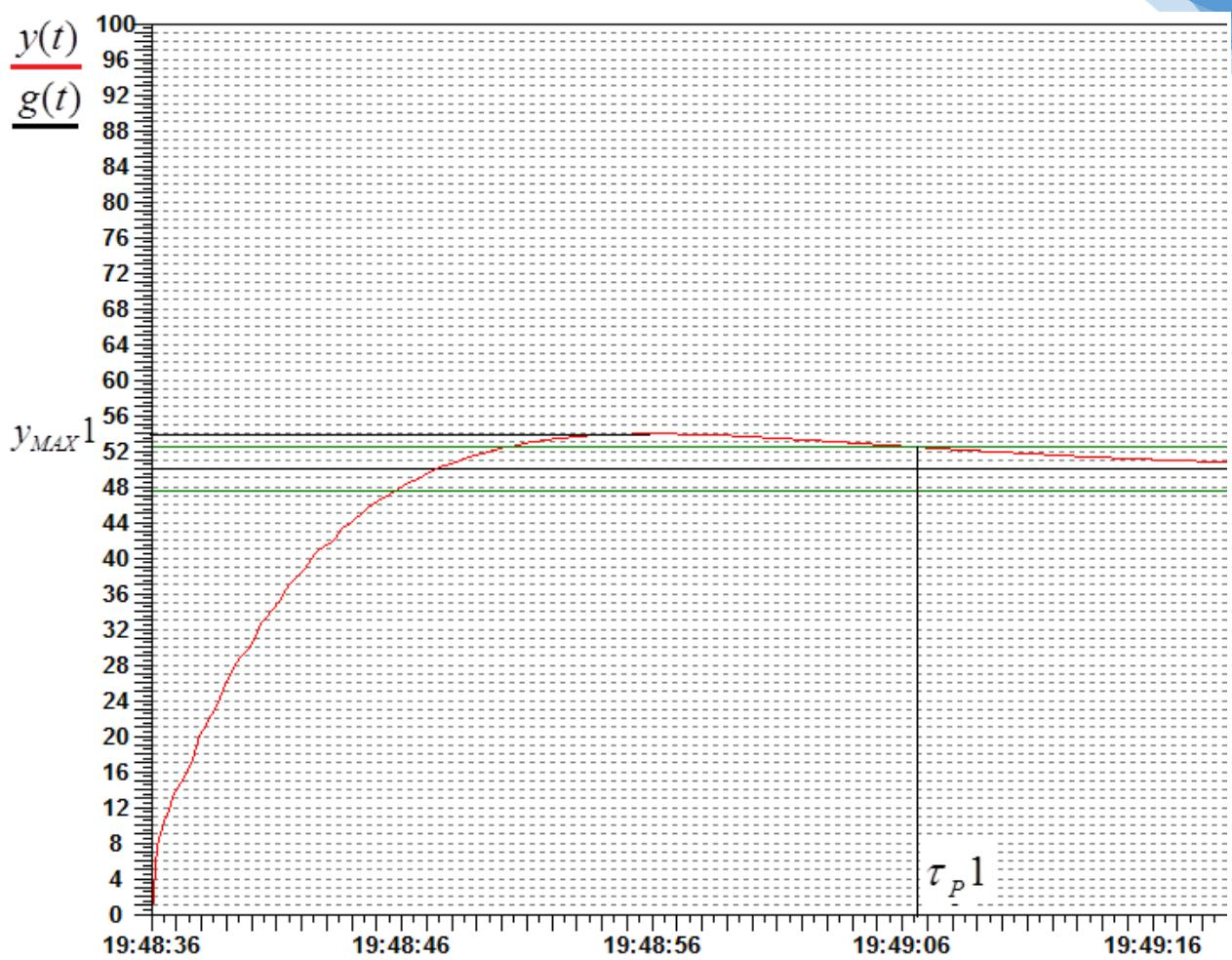
Где  $\delta_1$  -перерегулирование,  $\tau_p 1$  -время регулирования.
