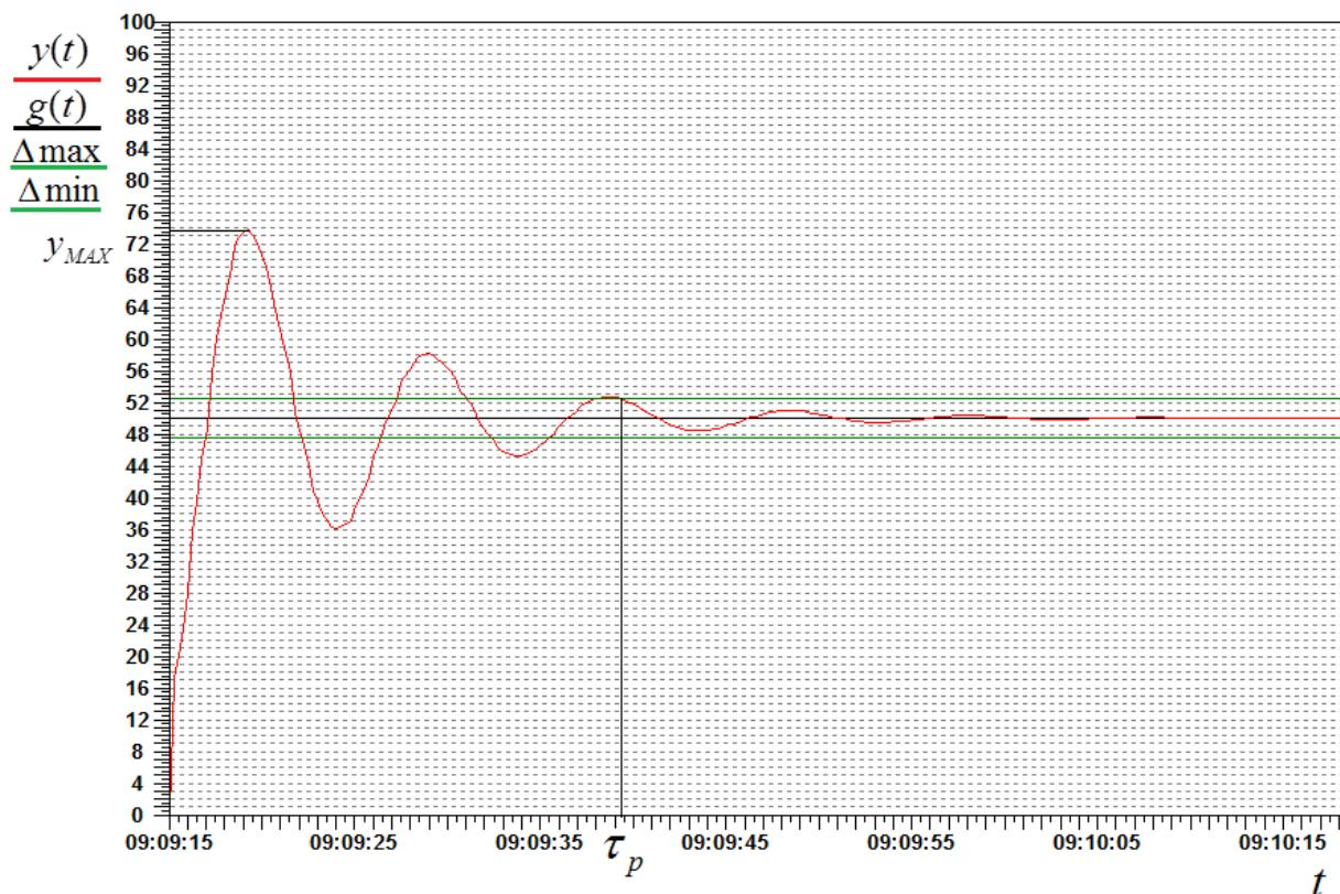
Где  $y_{MAX}$  - максимальное значение управляемого параметра, соответственно  $\delta = \frac{y_{MAX} - g(t)}{y_{MAX}} \cdot 100\%$  - перерегулирование,  $\Delta_{max}$  - верхняя граница зоны регулирования,  $\Delta_{min}$  - нижняя граница зоны регулирования,  $\tau_p$  - время регулирования.
