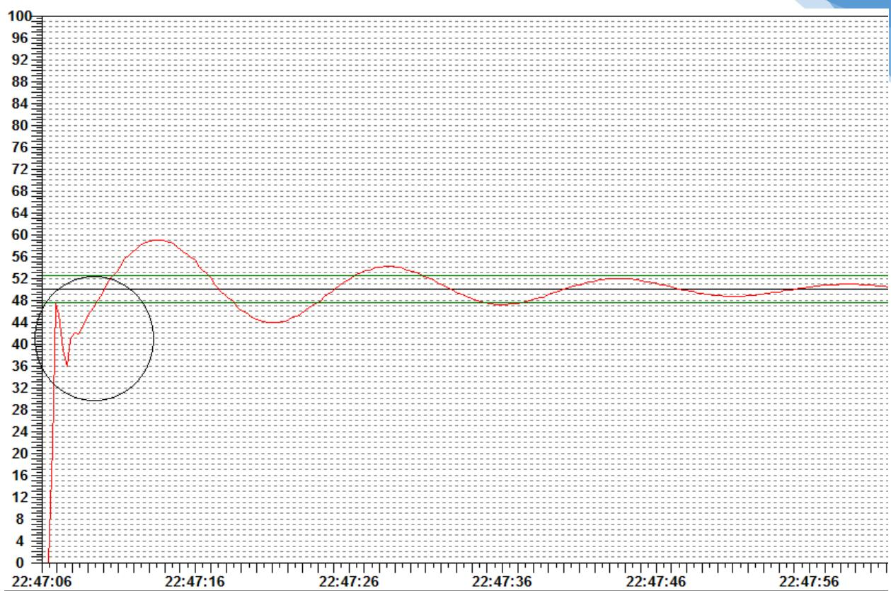
На графике виден участок, на котором дифференциальная составляющая оказывает наибольшее воздействие. При уменьшении коэффициента дифференциальной составляющей таких участков станет больше.
