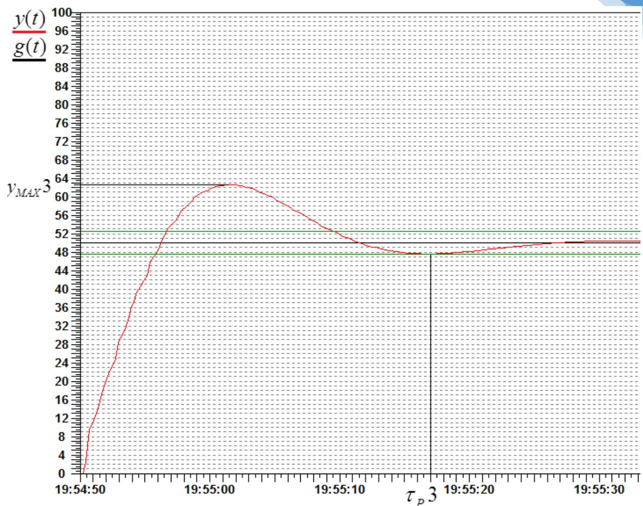
Где  $\delta_3$ -перерегулирование,  $\tau_p$ -время регулирования.
