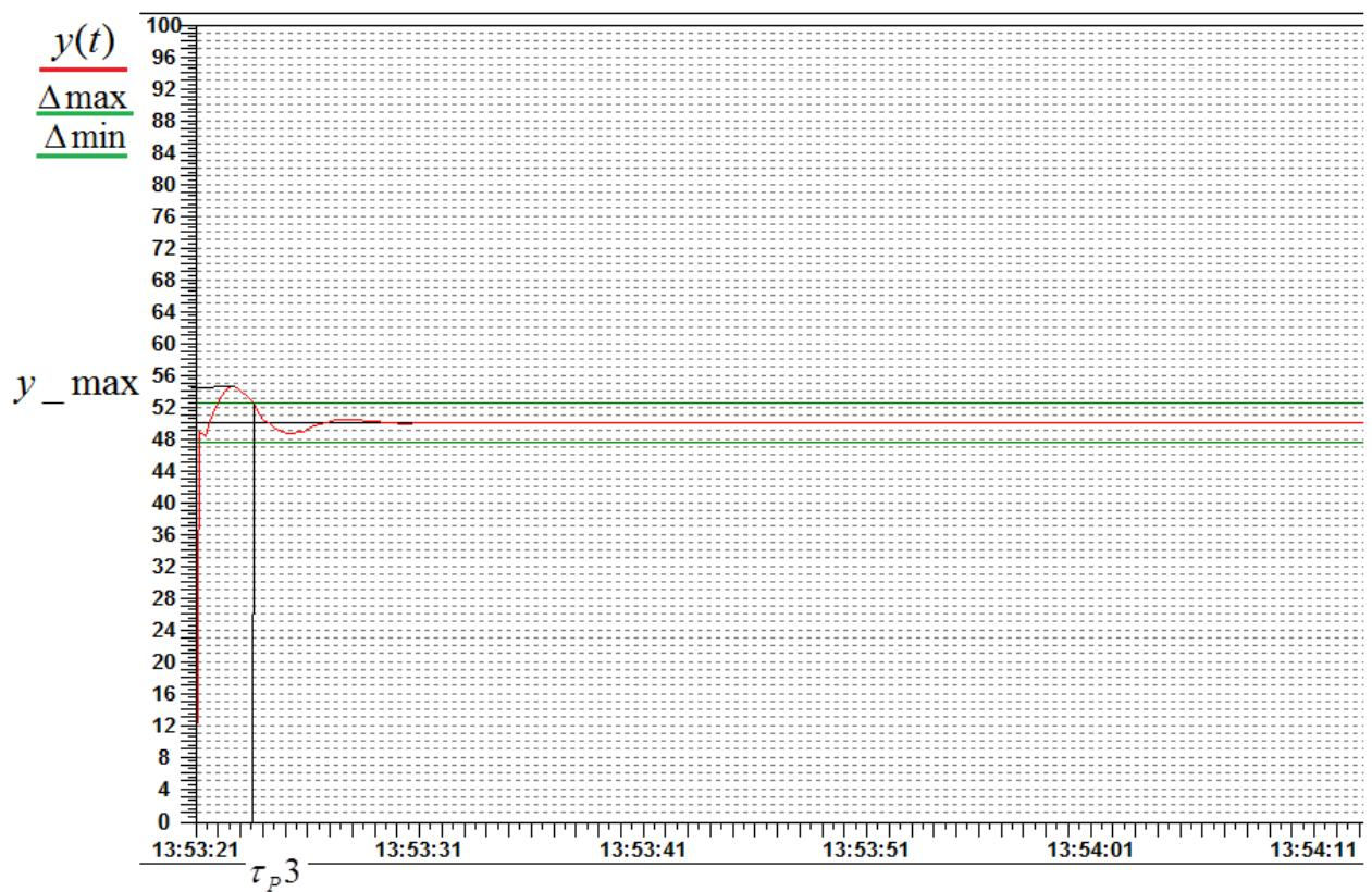
При увеличении коэффициента пропорциональной составляющей  $K_p1 < K_p2 < K_p3$  наблюдается уменьшение перерегулирования  $\delta_1 > \delta_2 > \delta_3$  и времени регулирования  $\tau_1 > \tau_2 > \tau_3$ .
